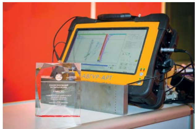
Универсальный дефектоскоп на фазированных решетках «АВГУР-АРТ»
