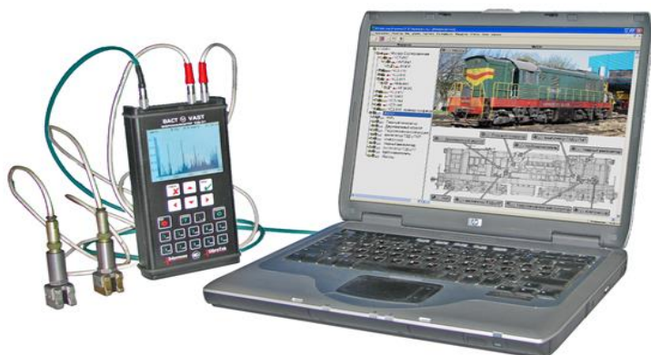
Рис. 2. Переносная система вибродиагностики на базе сборщика данных (виброанализатора) СД-21
